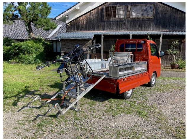
ダイハツ：農業用ドローンとドローン搭載ワンオペ化装置などを搭載した「ハイゼットトラック」
