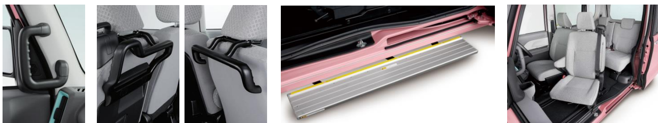
ラクスマグリップ (助手席) ラクスマグリップ (運転席/助手席シートバック) ミラクルオートステップ 助手席ターンシート
