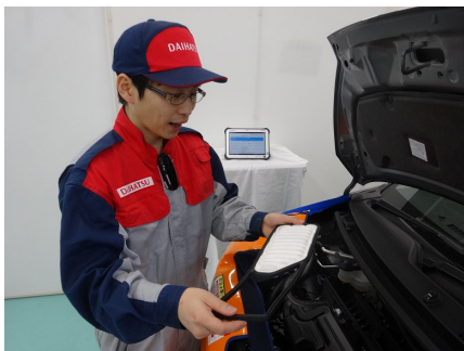
エアクリナエレメントを点検する様子。胸元のウェアラブルマイクを通し、奥のタブレット端末に点検結果が入力される
