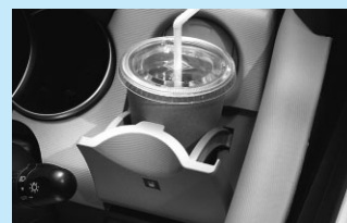
前席カップホルダー (インパネ・2個分・シンボル照明付・スローモーションオープン式)
