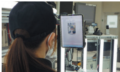
車両1台ごとの検査結果と3D顔データで登録された検査員の履歴をすべて残すことにより、厳格な検査を保証しています
