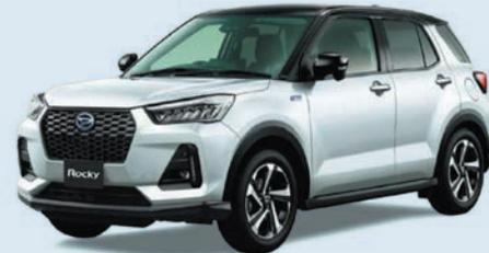
HEV「ロッキー」に搭載の「e-SMART HYBRID」は、エンジンで発電し、その電力を使用して100%モーターで走行するシリーズ方式を採用しています
