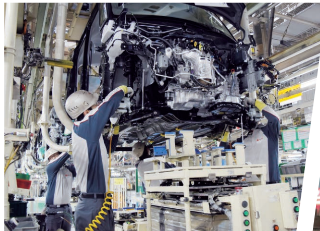
③生産 ※写真は、エンジン・ミッションの搭載工程
