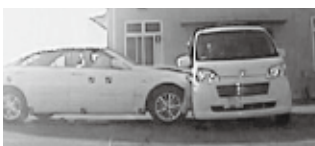
50km/hクルマ対クルマ側面衝突実験
