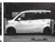
55km/h後面衝突実験
