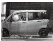
55km/h前面衝突実験
