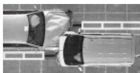
50km/hクルマ対クルマ前面衝突実験
