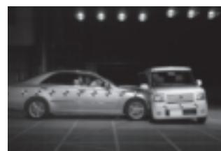
50km/hクルマ対クルマ側面衝突実験
