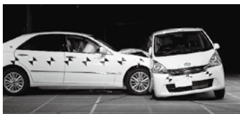
50km/hクルマ対クルマ側面衝突実験
