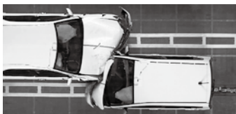
50km/hクルマ対クルマ前面衝突実験
