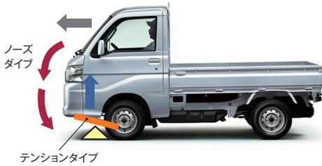
**テンションタイプ** サスペンションアームを車両前側に取り付ける構造。タイヤに後向きの力が入ると車体が沈み込む（ノーズダイブ）量が増加する。
