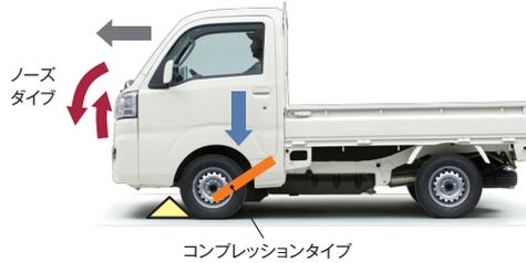
**コンプレッションタイプ** サスペンションアームを車両後側に取り付ける構造。タイヤに後向きの力が入ると車体の沈み込みを相殺する力が働く（一般的な乗用車の構造と同じ）。
