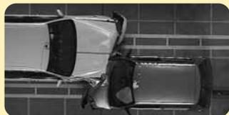
50km/h クルマ対クルマ前面衝突実験
