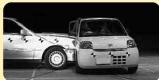
50km/h クルマ対クルマ側面衝突実験
